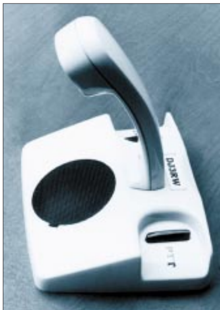
Bild 2: Auch das Gehäuse des FeTAP 711 bzw. 791 läßt sich bei einem Standmikrofon einsetzen.
