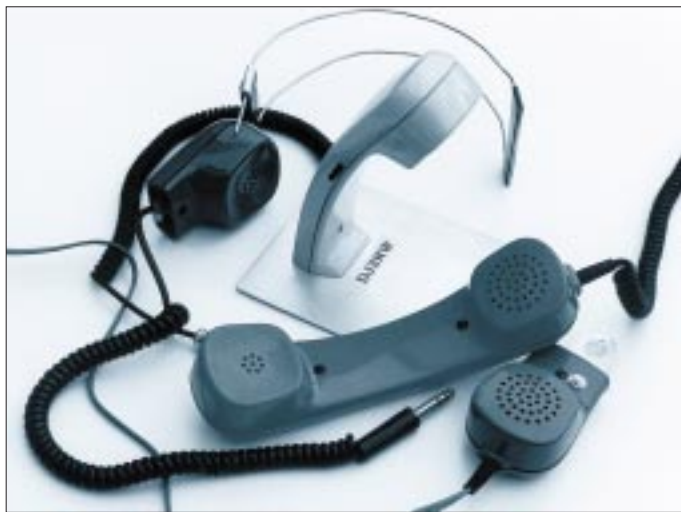
Bild 1: Verschiedene Varianten der Amateurfunkadaption von Posthörkapseln unter Verwendung von Teilen des Plastikhörers
