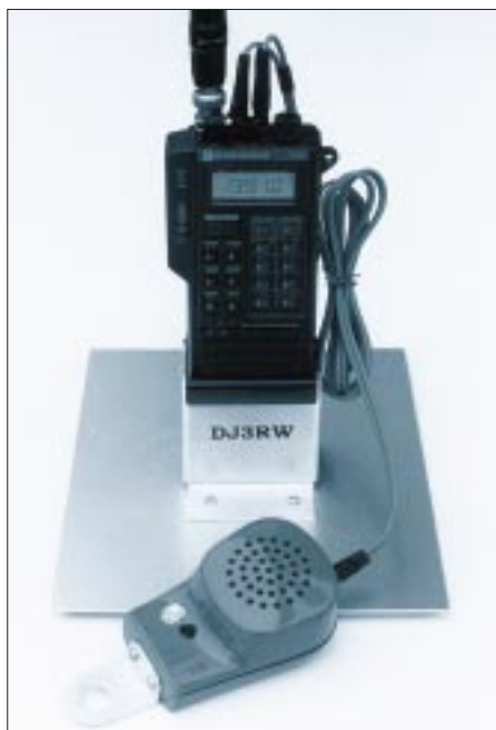
Bild 3: Handy als Feststation mit Telefonhörkapsel als Lautsprecher-Mikrofon
