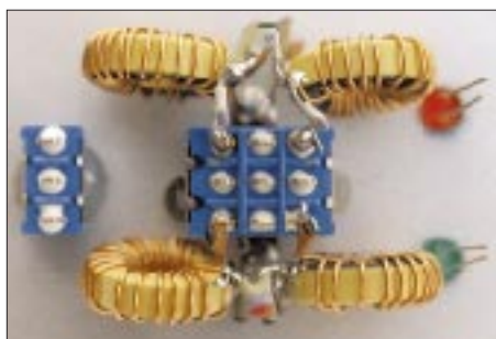
Bild 12: Die freitragende Befestigung der Bandpaß-Bauelemente an dem Band-Umschalter
